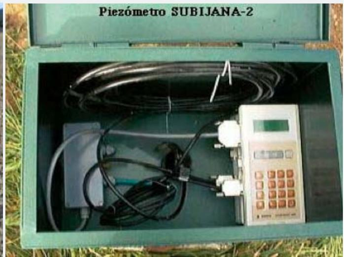
Equipamiento automático de control piezométrico instalado en el sondeo
