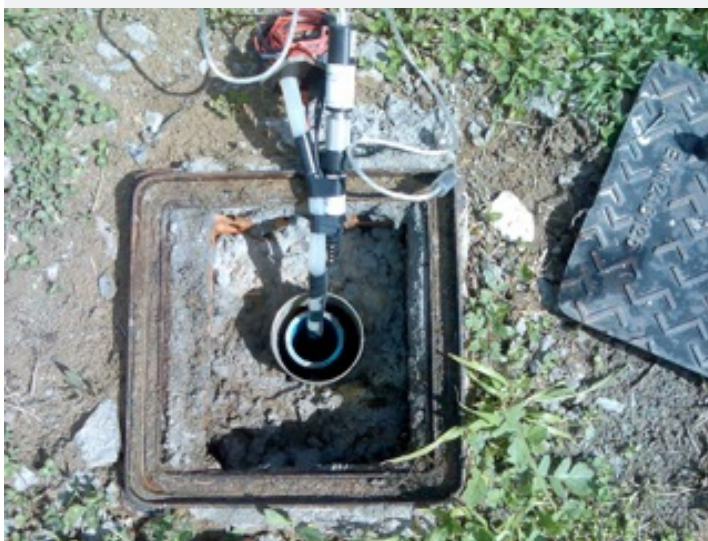
Detalle equipamiento para control automático de nivel y muestreo.
